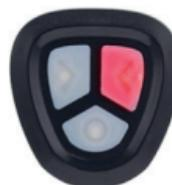
**Botão para ativar a luz à direita:** Pressione uma vez, a luz fluirá para a direita e pressione a luz novamente para desligar a luz em um curto período de tempo e, em seguida, retornar ao modo original.
