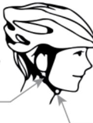
B. Le doigt peut être inséré dans la mâchoire inférieure
