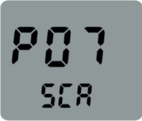
PAS level range setting interface
