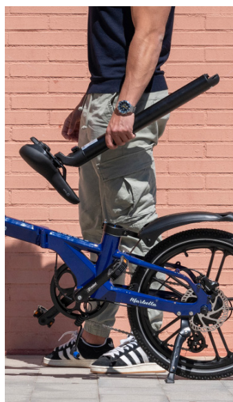
batería integrada en la tija del sillín
