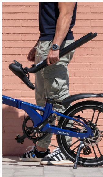
batteria integrata nel reggisella
