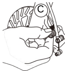
Fig. 15 Ajuste das pastilhas de travão de disco
