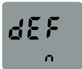
Restaura la interfície de configuració predeterminada
