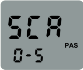
PAS level range selection interface
