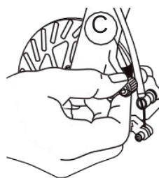
Fig. 15 Ajuste de las pastillas de freno de disco
