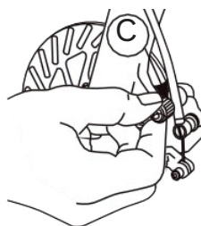
Fig. 15 Ajuste das pastilhas de travão de disco
